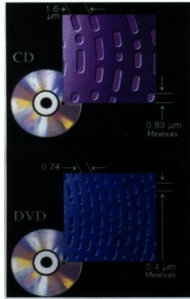
Şekil 13.18. CD-ROM ve DVD-ROM'daki bilgi taşıyan çukurların karşılaştırılması.
