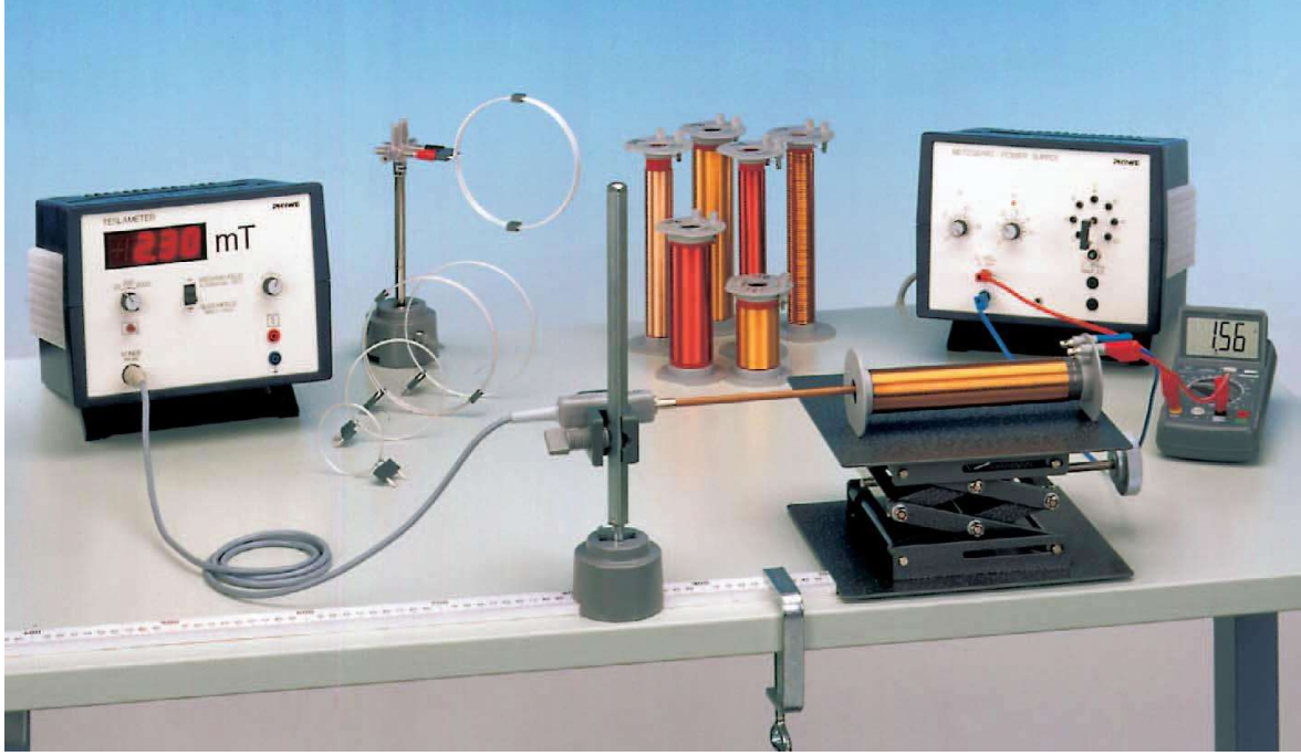
Şekil 5.4. İletken telin oluşturduğu manyetik alanın ölçülmesi devresi
