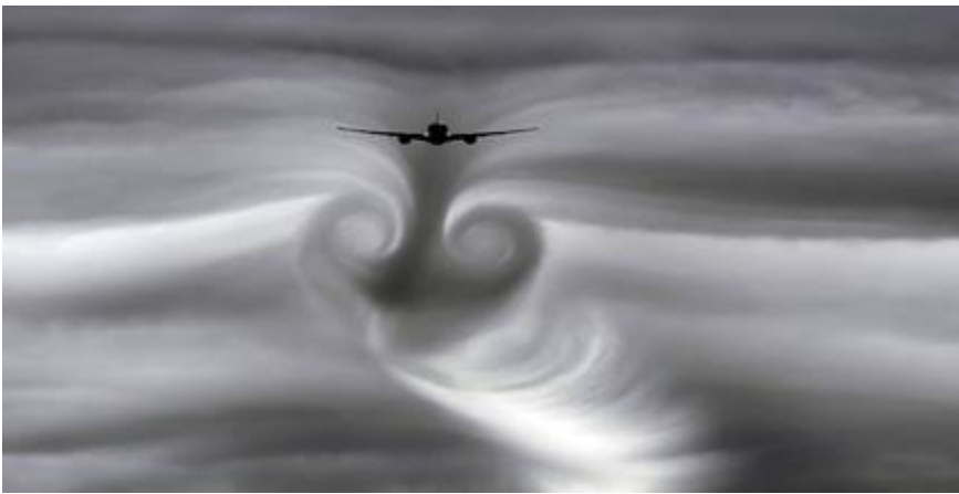
Resim 27: Dümen Suyu Türbülansı[13]
