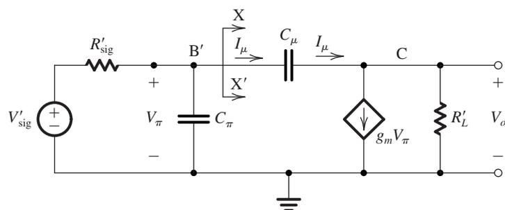
$$V'_{\text{sig}} = V_{\text{sig}} \frac{R_B}{R_B + R_{\text{sig}}} \frac{r_{\pi}}{r_{\pi} + r_x + (R_{\text{sig}} // R_B)} \quad R'_L = r_o // R_C // R_L$$
