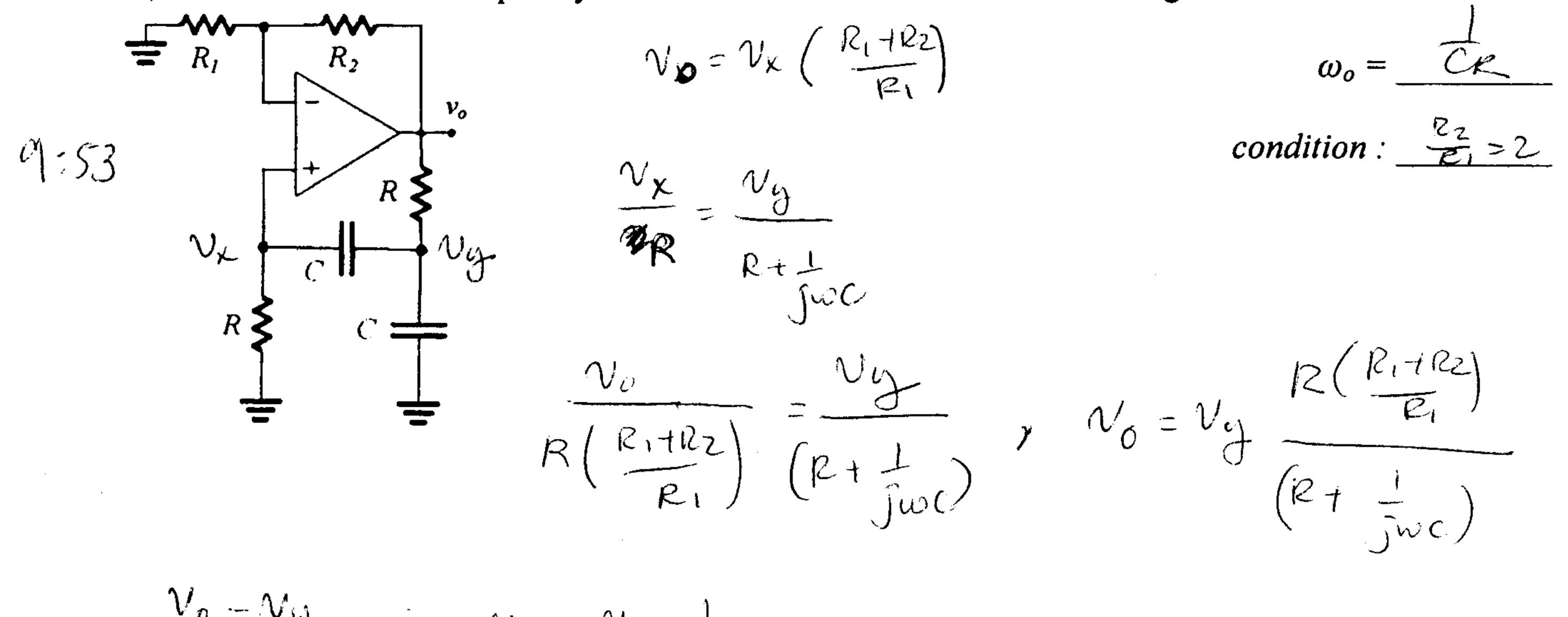
$\frac{v_0 - v_0 y}{R} = jwcvy + vy - \frac{1}{R+jwc}$
