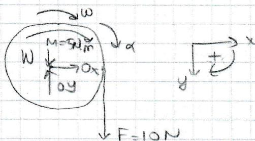
Disk saat yönü bir açısal hız sahip.  $\alpha$  açısal ivmesinin yönünü de kuvvet ve momentin uygulanma biçiminden dolayı saat yönü varsayıyalım.
