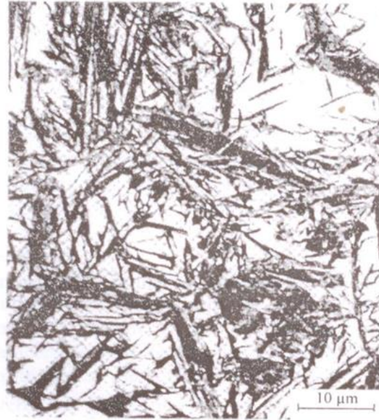
Şekil 7.11 Çeliklerde oluşan tipik bir martenzitik yapının görünümü. İğne biçimindeki taneler martenzit fazını beyaz bölgeler ise osteniti göstermektedir.
